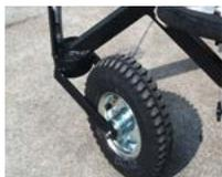
Le apparecchiature traccialinee sono disponibili inoltre nella versione con ruota girevole. Per mezzo di una leva posta sul manico è possibile regolare la rotazione della ruota in base alle proprie necessità.
